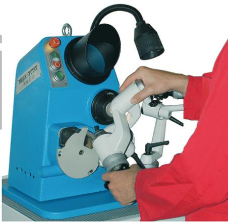
Hochpräzise, ergonomische und bedienerfreundliche Bohrerschleifmaschine mit optischem Projektionssystem, kosteneinsparend und in Schweizerqualität.
