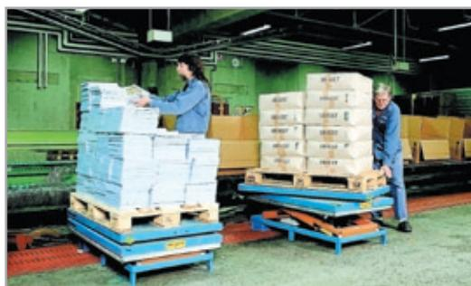
Mit einem erhöhten, verstellbaren Bodenrahmen kann der Hubtisch einfach von einem Stapler aufgenommen werden und lässt sich so an unterschiedliche Einsatzorte versetzen.
