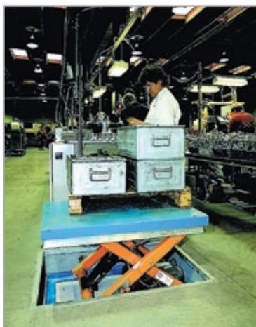
Alle Varianten der TransLift-Baureihe lassen sich ebenerdig platzieren, können aber auch im Boden eingelassen werden.
