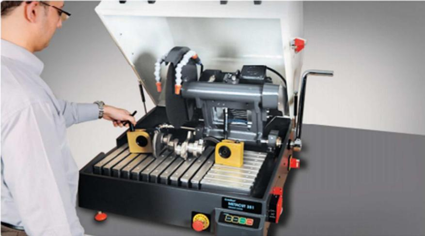
METACUT Maschinen erfüllen die höchsten Sicherheitsanforderungen. Die elektrische Überwachung verhindert das Starten des Motors ohne dass die Schutzhaube geschlossen wurde. Die elektrische Verriegelung verhindert das Öffnen der Schutztür bevor die Trennscheibe zum Stillstand gekommen ist.
