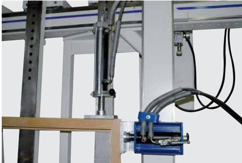
Der Schiebeschlitten für die Breitenverstellung ist durch eine Zentralverriegelung im 50 mm Lochraster einstellbar. Die HYDRO-Export verfügt über zwei stufenlos verstellbare horizontale Hydraulik-Presszylinder mit Gewichtsausgleich für jeden Presszylinder. Diese sind doppelt wirkend mit 80 mm Hub und 30.000 N Presskraft. Das durchgehende linke Widerlager für die Breitenverpressung ist 80 mm tief.
