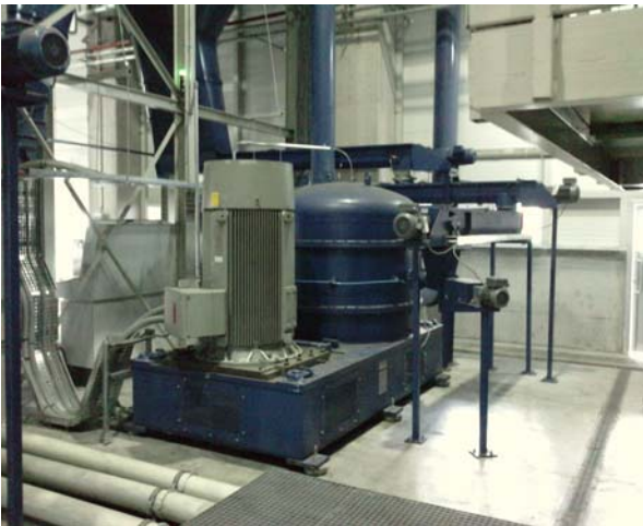
Rotormühle Typ SN mit 1,6 m Rotordurchmesser, 400 kW Antriebsleistung und 11 t Gesamtgewicht.
