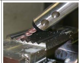
Fräsen profilierter Mahlbahnplatten
