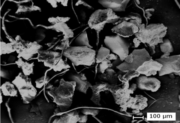
Selektives Zerkleinern von Verbundstoffen (hier Vermahlung von Altreifenchips)
