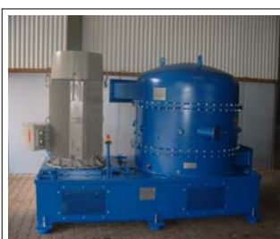
Rotormühle fertig montiert
