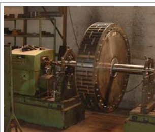
Wuchten eines Rotors
