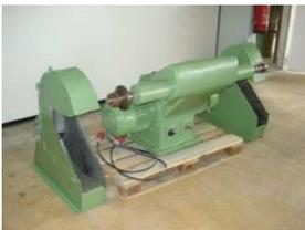
Doppelseitiger Polierbock, inkl. Standpolierhauben, 2 x 3 kW, Drehzahlen 1700 / 2200 U/min. über Riemenscheiben
