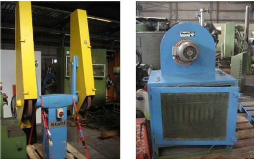
doppelseitiger Bandschleifer, ca. 2,2 kW, Bandlänge 2500 mm, Wellendurchmesser 35 mm, Kontaktscheibe Ø 450 x 50 mm, inkl. Staubabsaugung Venti Oede
