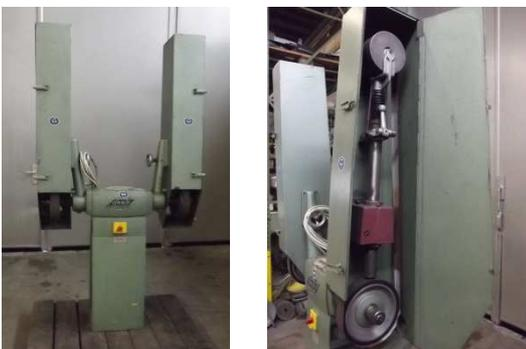
GREIF DV 30 - 2 – 2, doppelseitiger Bandschleifbock, 2 x Bandspannarm mit Bandschutzkasten, Wellendurchmesser 30 mm, Schleifband 50 x 2000 mm, inkl. Kontaktrollen 50 x 250 mm, 2,5 kW, 380 V, 50 Hz, Drehzahl ca. 3000 min-1
