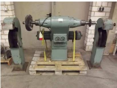
2 x 3,7 kW, Drehzahlen 1800 / 2200 / 2800 U/min. über Keilreimen, Wellendurchmesser 30 mm, inkl. 2 Standpolierhauben
