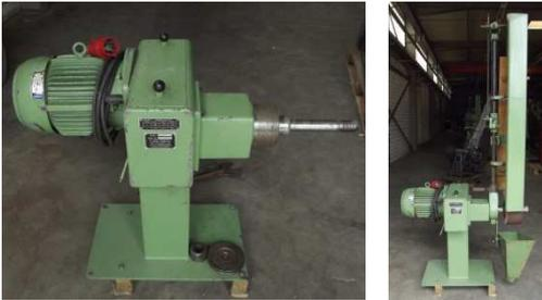
einseitiger Polierbock / einseitiger Schleifbock, 5,5 kW, Wellendurchmesser 35 mm
