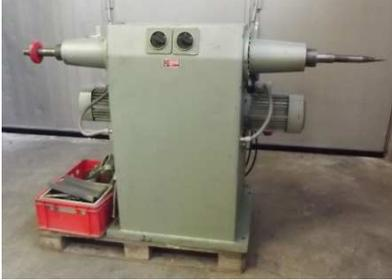
2 x 3 kW, Drehzahlen jeweils 1400 / 1800 / 2200 U/min., Wellendurchmesser 35 mm, Spindelhöhe ca. 1000 mm für stehende Arbeitsweise, Maschine gereinigt und getestet, läuft einwandfrei
