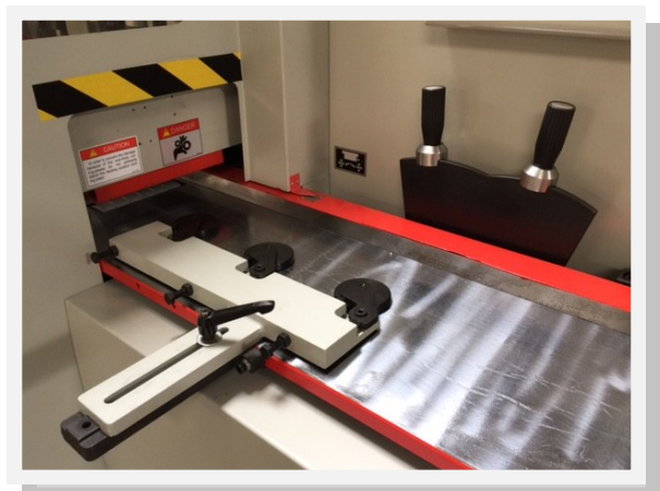
Maschinentische hart verchromt 0,3 mm
