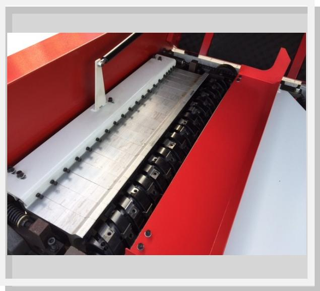
Spiral - Messerwelle  $\varnothing$  120 mm
