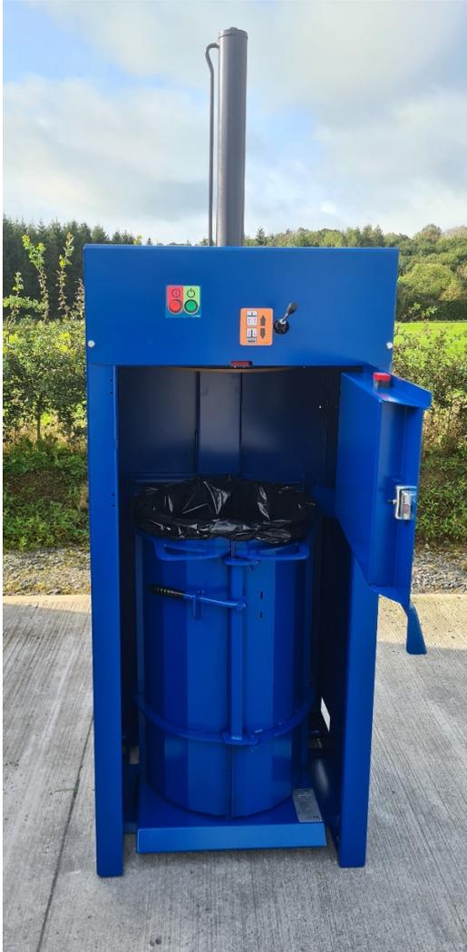
Der BTS-240 Müllverdichter ist ideal für das Verdichten Ihrer 240 Ltr. Müll- und Wertstoff-Behälter. Mit ihm wird voluminöser Abfall und Wertstoff einfach und sicher auf ein Minimum seiner Größe verdichtet.
