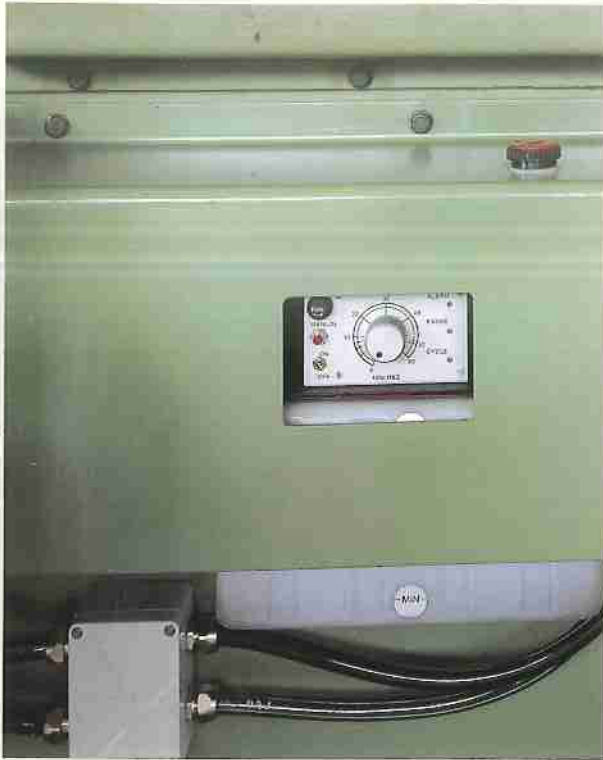
Centralina di lubrificazione automatica temporizzata Automatic station for lubrication Distributeur de lubrification automatique Vorrichtung für die automatische und temporisierte Schmierung Equipo de lubrificación automatico
