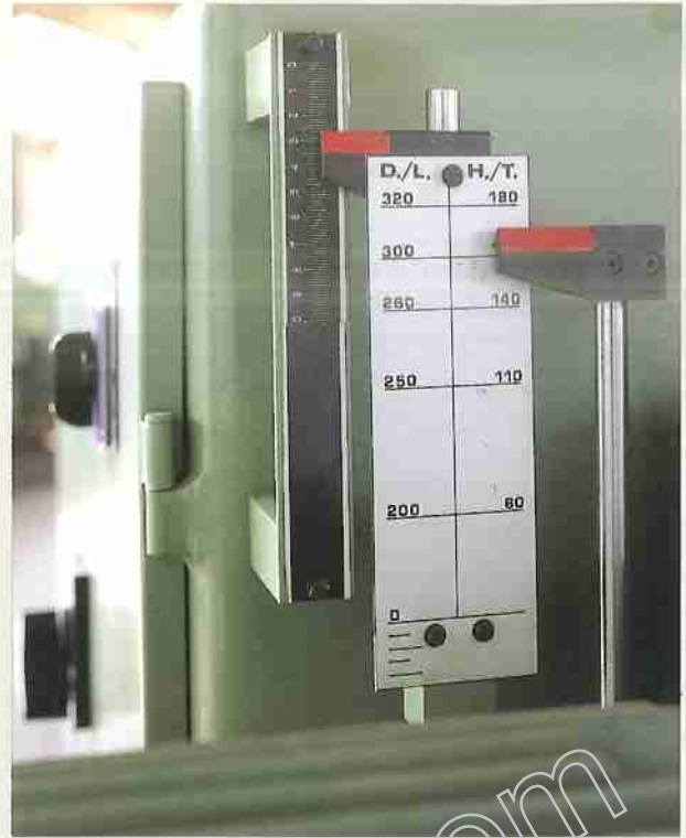
Indice centraggio gruppi lame in funzione dell'altezza di taglio Centering index of saws units with regards to the cut depth Indice de centrage groupes lames en fonction de l'hauteur de coupe. Zentriervorrichtung der Position der Blätter, abhängig von der Schnitthöhe Indice para centrar los grupos hojas sur altura de corte.
