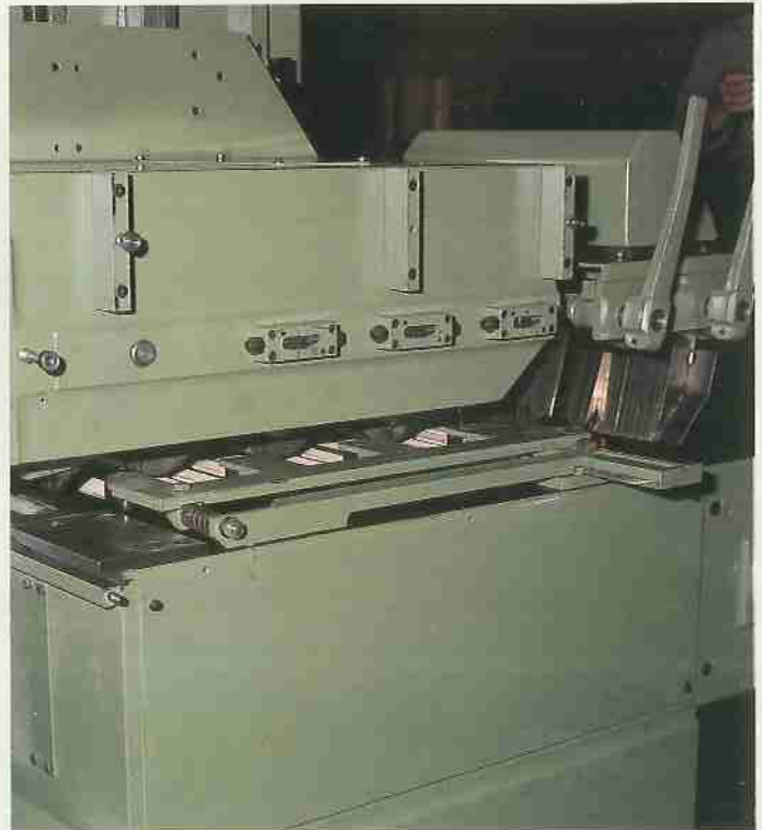
Applicazione per produzione di stecche per letti ortopedici Equipment for orthopedic beds' splints processing Application pour produire eclisses pour lits orthopediques Vorrichtung für die Herstellung von orthopädischen Schienen für Betten Equipo para cortar cintas de camas ortopedicas
