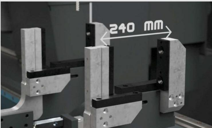
Las innovadoras pinzas Kronos permiten el mecanizado de perfiles hasta 240 mm
