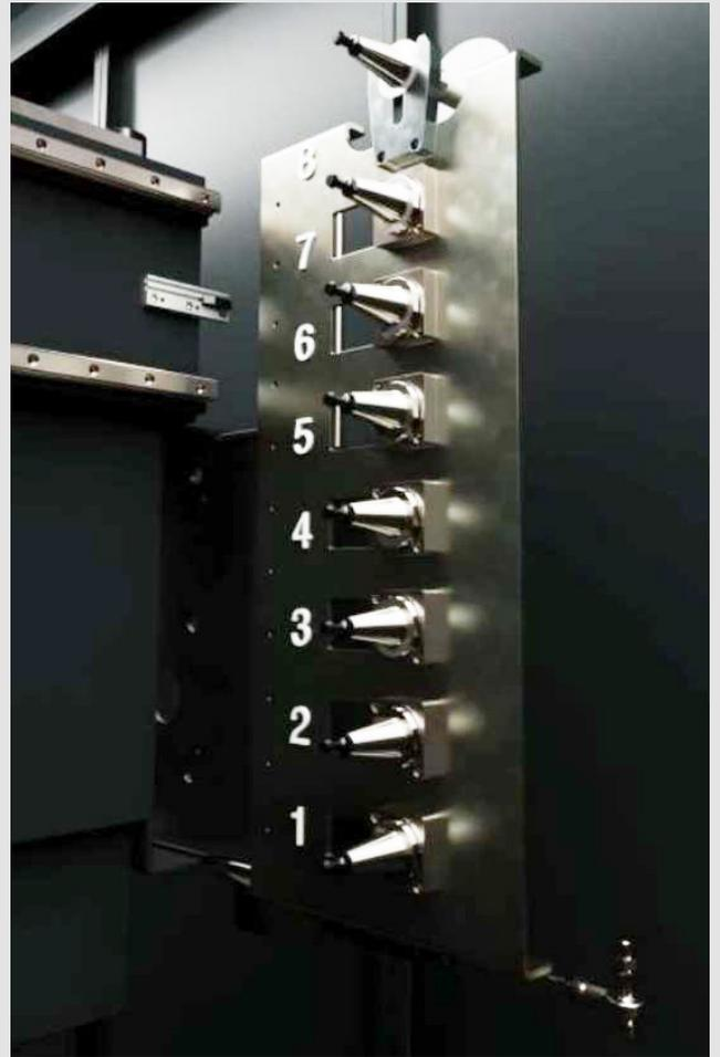
Cargador de herramientas de 8 posiciones fijado al carro
