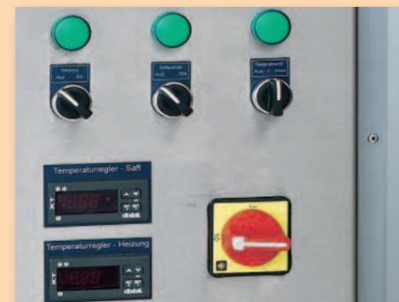
Bedienkonsole mit Digitalanzeigen für Saft- und Wassertemperatur
