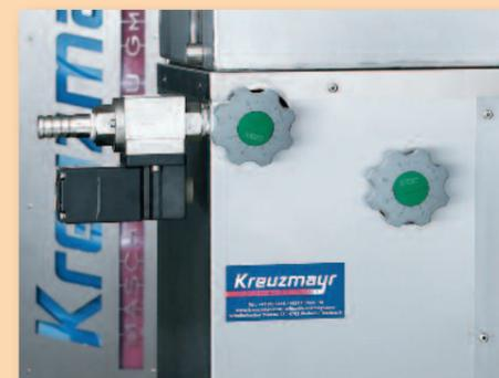
Saftventil mit Mengenregulierung und Bypass
