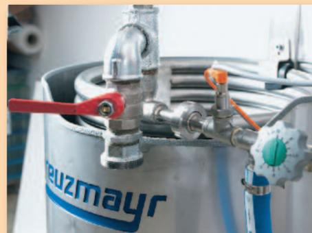
Rohr-in-Rohr Wärmetauscher mit Heizmediumanschluss und Mengenregulierung
