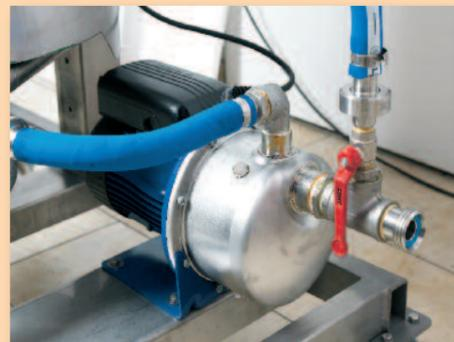
Leistungsstarke Saftpumpe mit Bypass-Ventil
