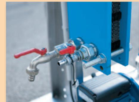
Platten-Wärmetauscher mit Ablaufarmaturen
