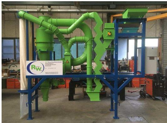
Bsp.: Separation mit semi mobil Zick Zack Sichter Anlage ZZS 200-15-SM
