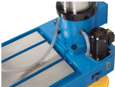
Große Ausladung und Schwenk- und drehbarer Arbeitstisch
