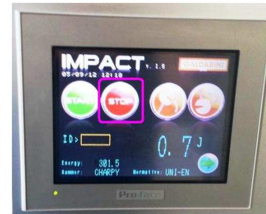
Touch-Monitor für Bedienung und Konfiguration
