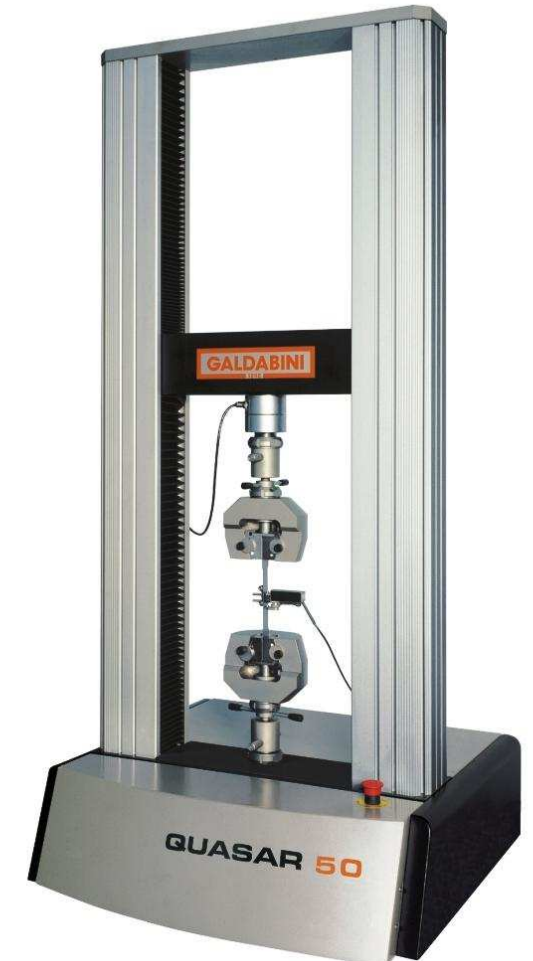
QUASAR 50 kN Optionen: manuelles Keilschraubspannzeug, Anklemm-Feindehnungsmesser
