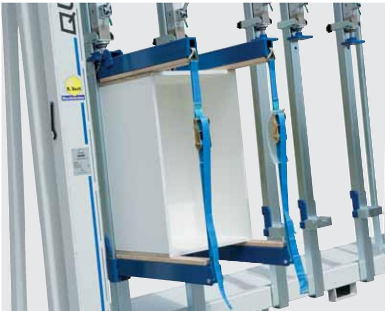
Die Herstellung eines geschlossenen Möbelementes wird mit der QUATTRA- Korpuspresse zum Kinderspiel. Gegenlager und Press-element werden einfach auf den passenden Vertikaldruckbalken befestigt und in die richtige Position gebracht. Zur rechtwinkligen Pressung werden die Presselemente durch feinjustierbare Gurte unterstützt.
