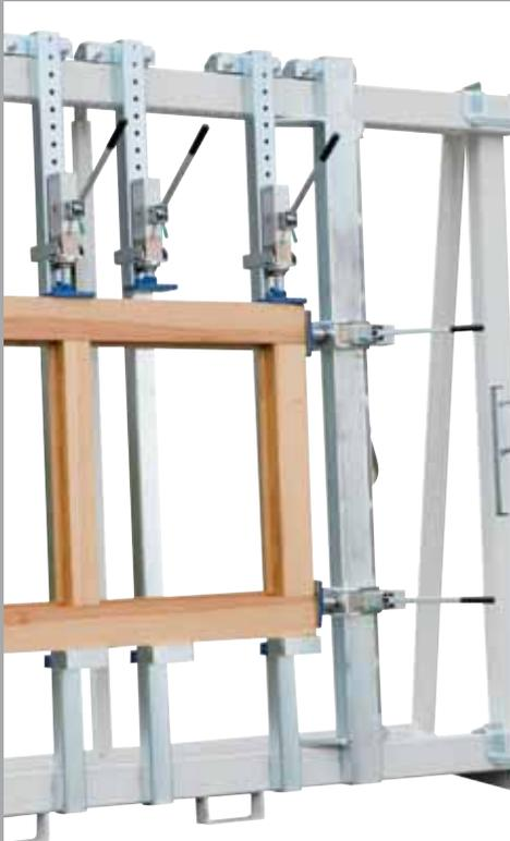
Manuell und hydraulisch betätigt oder elektrohydraulisch per Knopfdruck bewegt - QUATTRA-Besitzer haben die Wahl.
